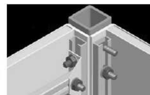
Теплоизоляция стеновых элементов без «мостиков холода»
