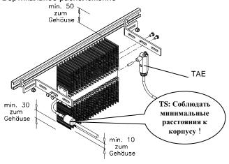
Изображённые уголки из оцинкованной стали и крепёжные болты входят в объём поставки. Кроме того к ТАЕ прилагается короткий резьбовой штифт для монтажа на нагреватель.
